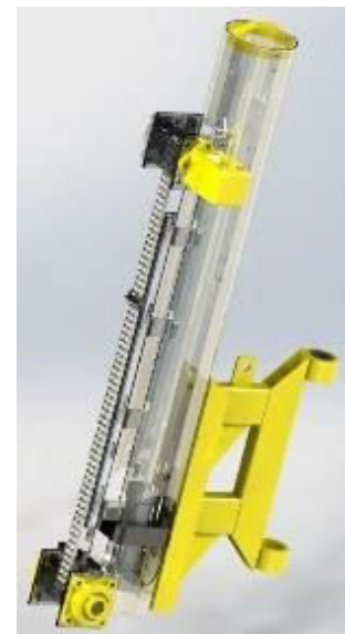
Battage SPT automatique
